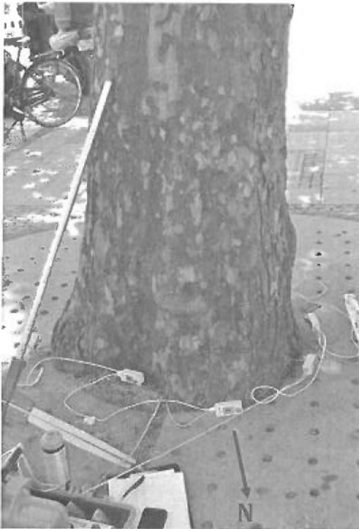
Abb. 3 und 4: am Stammfuß angebrachte Arbotom-Sensoren.
